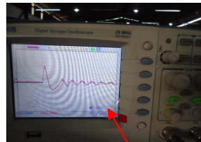
REALIZADO ENSAIO LÂMINA A LÂMINA - 183 LAMINAS - FORMA DE ONDA SEM ANORMALIDADES
