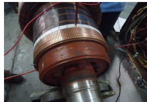
REALIZADO ENSAIO LÂMINA A LÂMINA - 183 LAMINAS - FORMA DE ONDA SEM ANORMALIDADES
